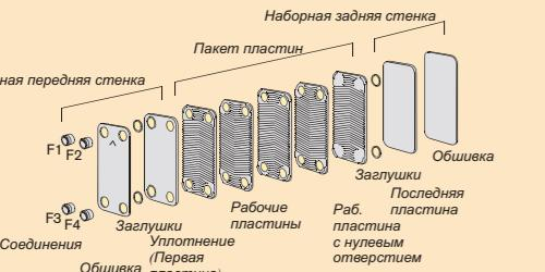
В КПТ рабочие среды могут двигаться в различных направлениях. В КПТ с параллельными потоками различаются два направления: противоточное и прямоточное.
