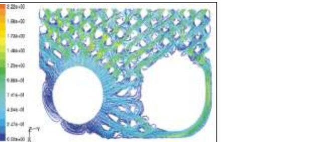
Моделирование – один из важнейших инструментов для разработки новых и совершенствования существующих КПТ. Оценка различных видов пластин с помощью моделирования расходов и направлений позволяет улучшать рабочие параметры теплообменников.
